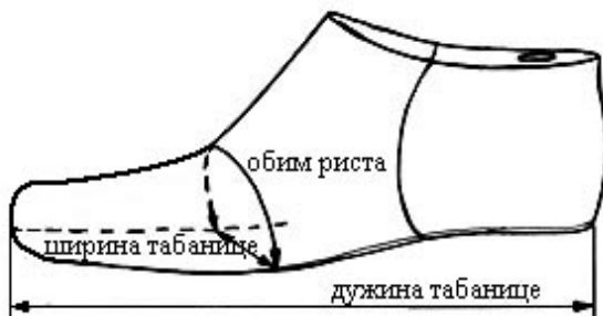
Слика 1 – Основне димензије калупа
